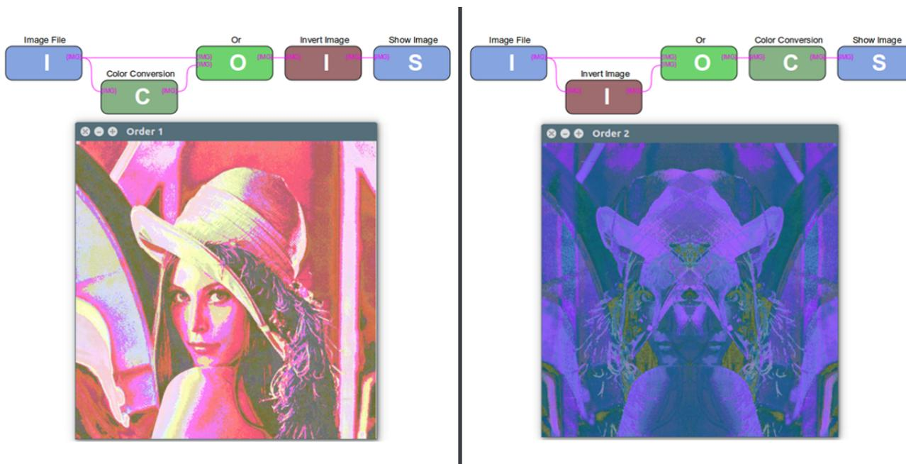
Figura 5: Exemplo de um diagrama disposto em seqüências distintas no Mosaicode e os resultados de sua execução.
