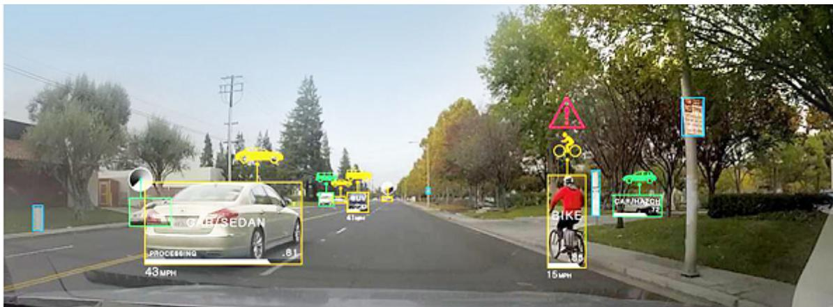
Figura 1: Visão Computacional utilizada para detecção de carros, pedestres e ciclistas.
